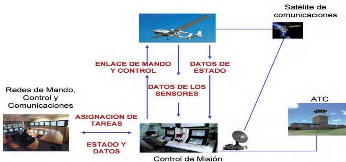
Fig. 1. Enlaces en un sistema de aeronave no tripulada. Fuente Ministerio de Defensa
