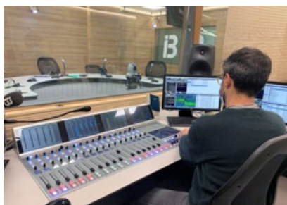
Control de producción de una emisora de radio. Dependiendo de sus características, los programas se hacen desde el mismo control o con el apoyo del locutorio anexo, separado con un visor.
