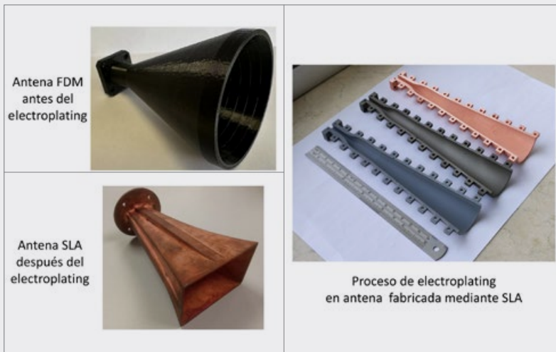
Antenas de radiofrecuencia fabricadas en impresión 3D de plástico y electroplating para aplicaciones 5G satelitales.
