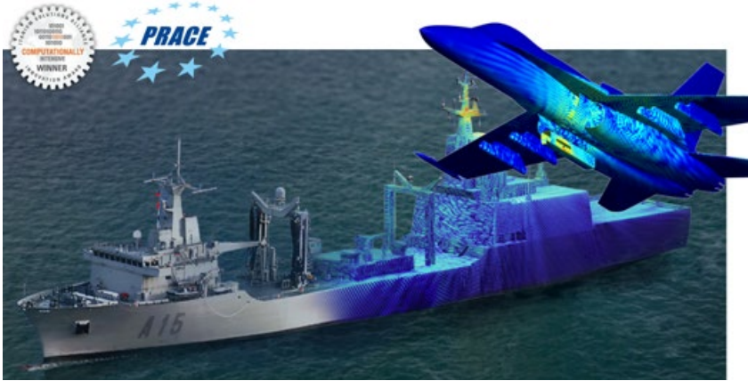
Corrientes inducidas por la radiación de una antena embarcada, sobre la superficie de un barco y la de un avión (UVIGO-UEx). Premio europeo PRACE de computación.
