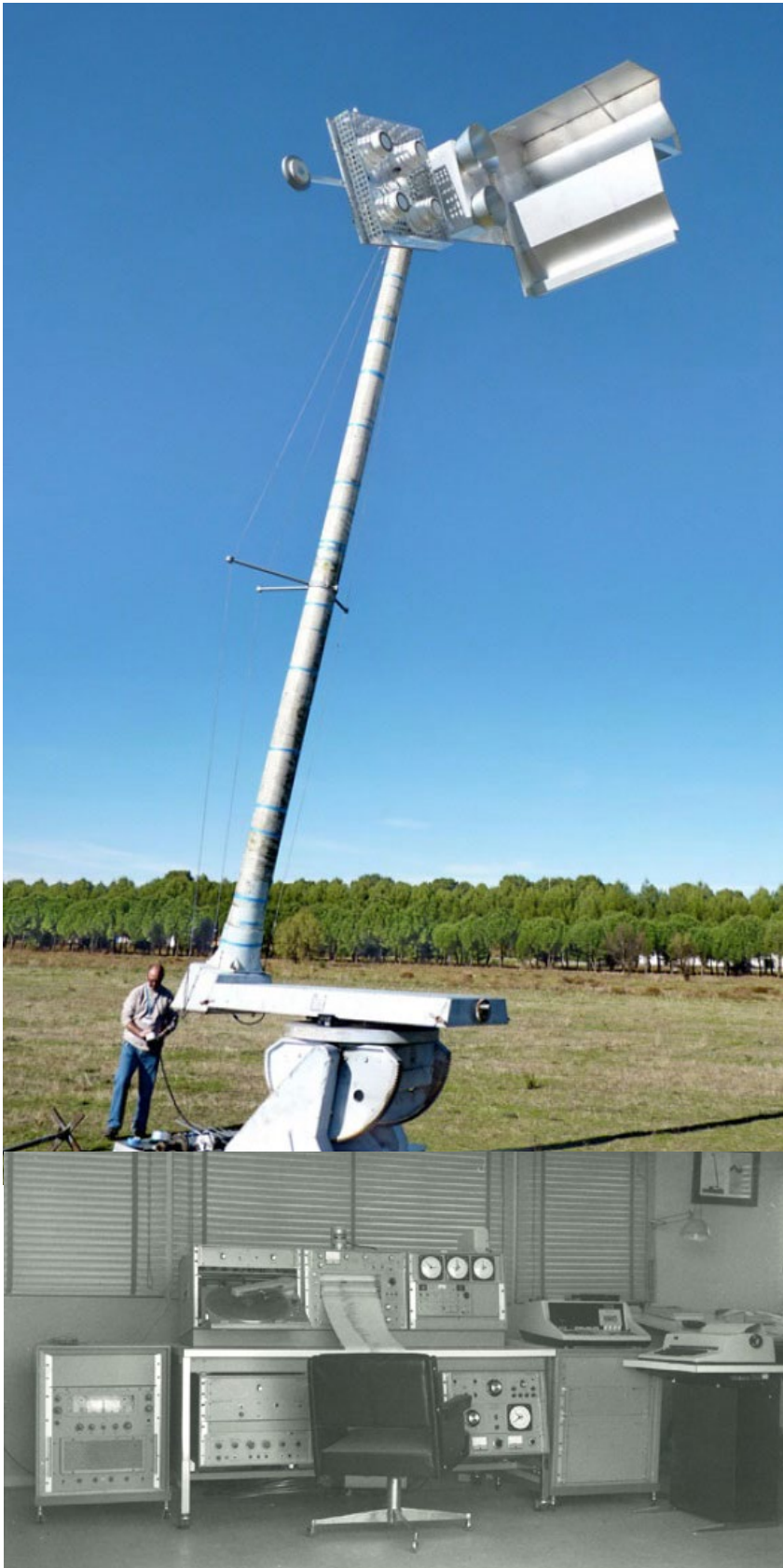
Foto 1. Posicionador en campo abierto por reflexión en el suelo del INTA.
