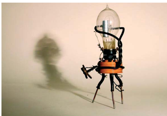
Válvula oscilante o diodo Fleming de 1904.
