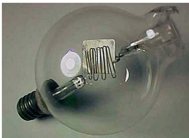
Detector audión DeForest. Se caracterizaba por su baja calidad.
