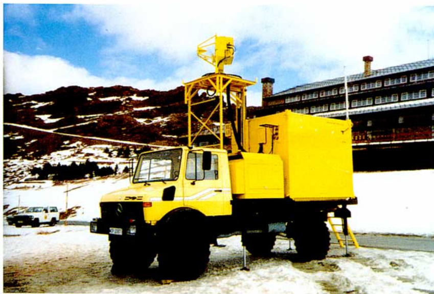
Unidad móvil de microondas realizando tareas de CTER en Sierra Nevada
