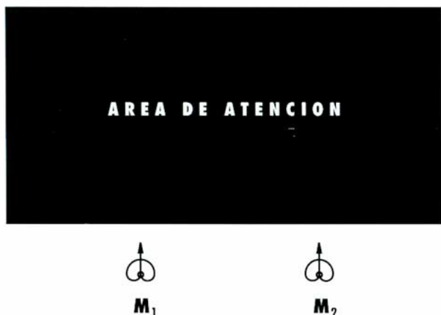
Disposición de los micrófonos para la toma de sonido estereofónica de dos canales
