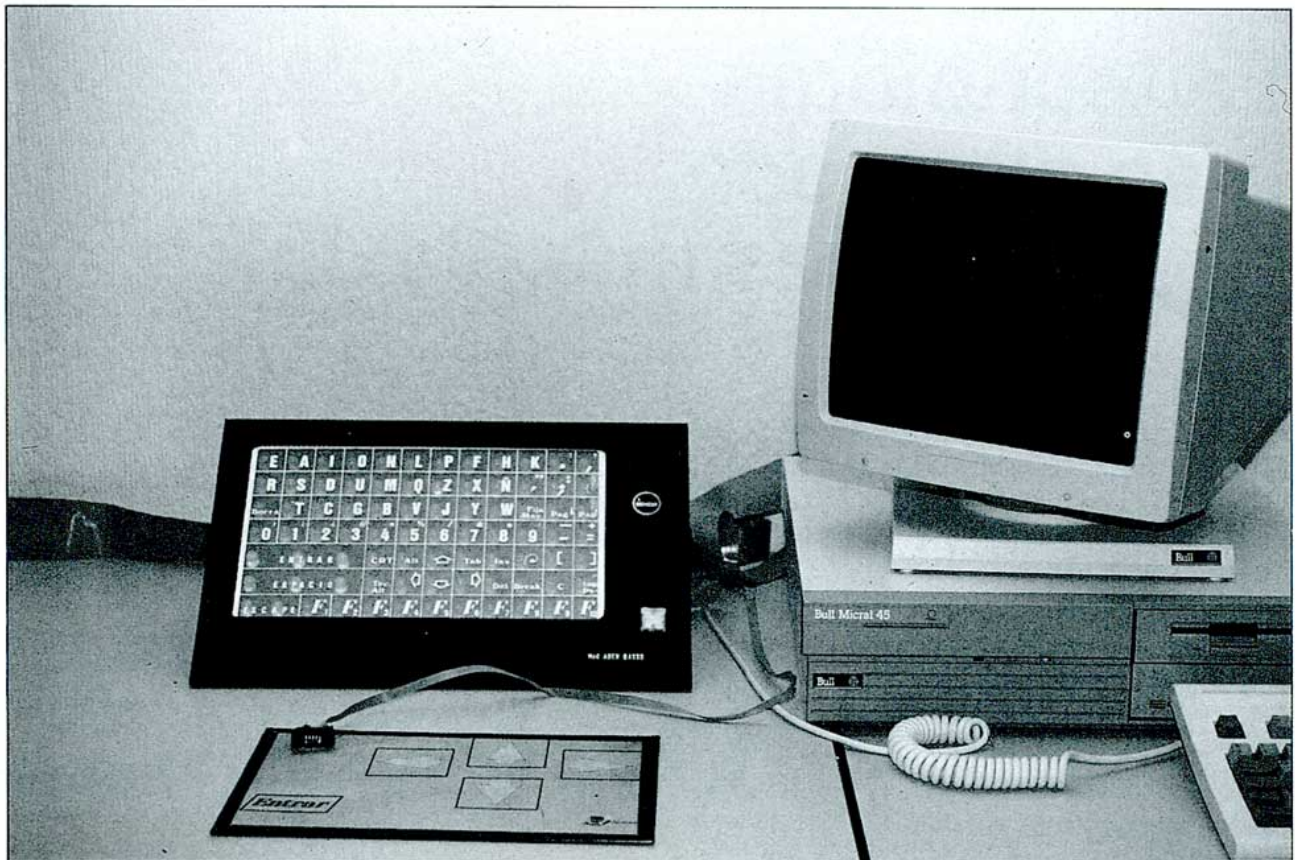
Emulador de teclado de ordenador con pulsador de cinco direcciones.
