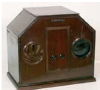
Televisor mecánico de Baird de 1928. Se estima que fueron construidos unos 30 receptores de este modelo.
