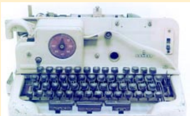
Perforadora, fabricada por Siemens. Se utilizó entre 1950 y 1960. Derecha, receptor de radio de principios de los años 30 del siglo pasado
