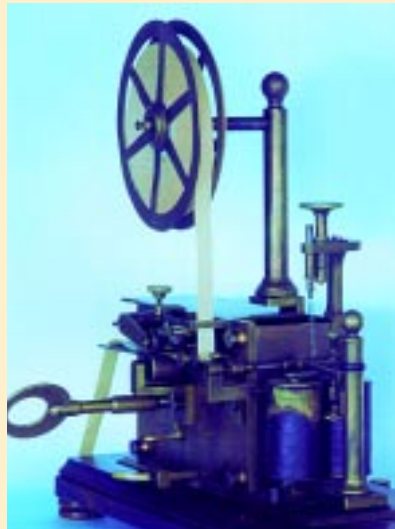
Izquierda, inscriptor de Morse. Fabricado en Francia en 1868. Derecha, alimentación y resto del equipo de radar Marconi tipo NT-100M
