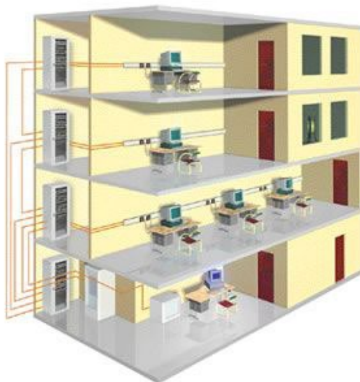
Esquema de una red de cableado estructurado o red multiservicio
