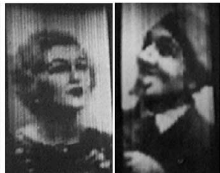
Izq.) Receptor de televisión de Baird de 1930 funcionando en Onda Media a 30 líneas verticales de resolución (fotografía obtenida a partir de un folleto publicitario, en el que la relación de aspecto se ha hecho más cuadrada que la real de 3/7). Centro y Dcha.) Imágenes obtenidas, donde pueden apreciarse claramente el sentido de exploración vertical y un formato de presentación de 3/7.
