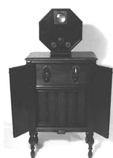
Receptor de televisión en forma de octógono (modelo “octagon”) fabricado en 1928 por la General Electric Company. Se utilizó para recibir las imágenes transmitidas en la banda de 2 MHz. en los Estados Unidos.
