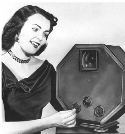
Receptor de televisión en forma de octógono (modelo “octagon”) fabricado en 1928 por la General Electric Company. Se utilizó para recibir las imágenes transmitidas en la banda de 2 MHz. en los Estados Unidos.
