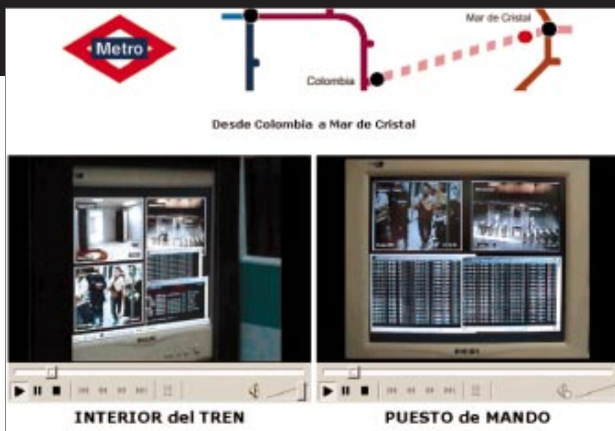
Figura 2. Proyecto TEBATREN: Imágenes en tiempo real del interior del tren vistas desde el Puesto de Mando y desde el propio interior del tren donde se ve, además, el aspecto del andén antes de llegar a la estación. Pruebas realizadas entre las estaciones de Mar de Cristal y Colombia..
