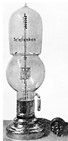
Válvula Lieben. Se puede apreciar en un costado el pequeño depósito de mercurio.
