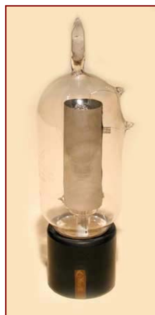
Válvula Round. Puede verse el apéndice superior con un trozo de asbesto.
