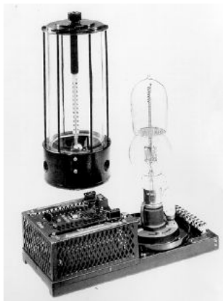
Amplificador de señal con un tubo Lieben y el estabilizador de temperatura.
