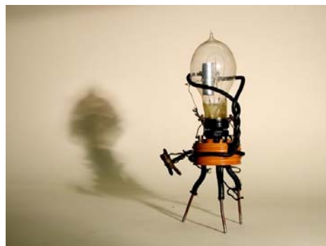
Válvula experimental que usó Fleming en 1904
