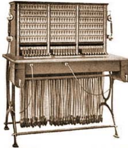
Fig. Central de llamada magnética 1900
